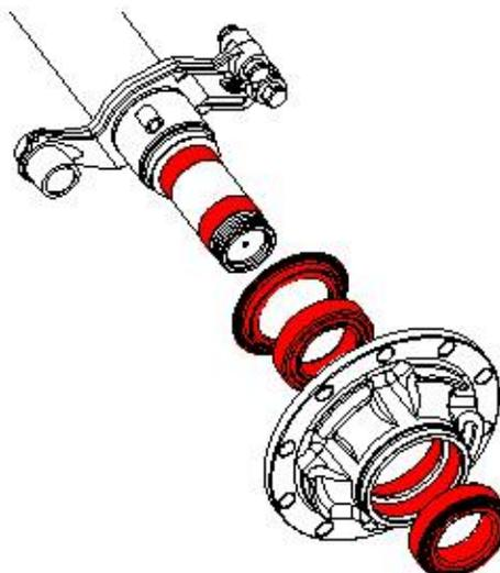
[12] Hinteres Kegelrollenlager demontieren
