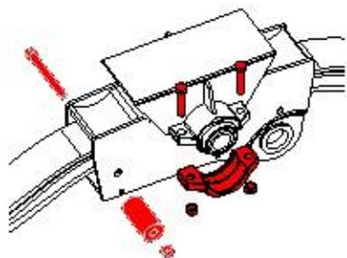
**4.2.2 SILENTBLOCK AM LENKERARM DE-/MONTIEREN**
