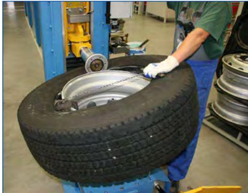
5. Nehmen Sie anschließend das Kompletttrad von der Montagemaschine ab.
