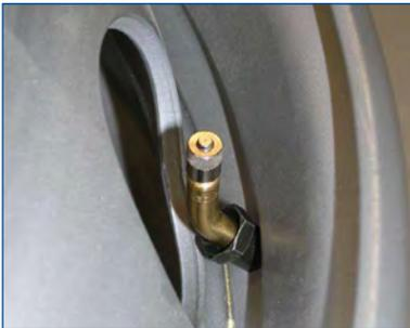
2. Setzen Sie nach der Montage des Ventils den internen Sensor auf der Innenseite der Felge auf den Ventilkopf (Abbildung 2) und fixieren Sie ihn mit der Schraube (Abbildung 3). Beachten Sie dabei Folgendes:
