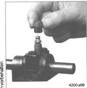
Abb. 2-1 Zerk-Lock-Körper auf den Schmiernippel set-zen
