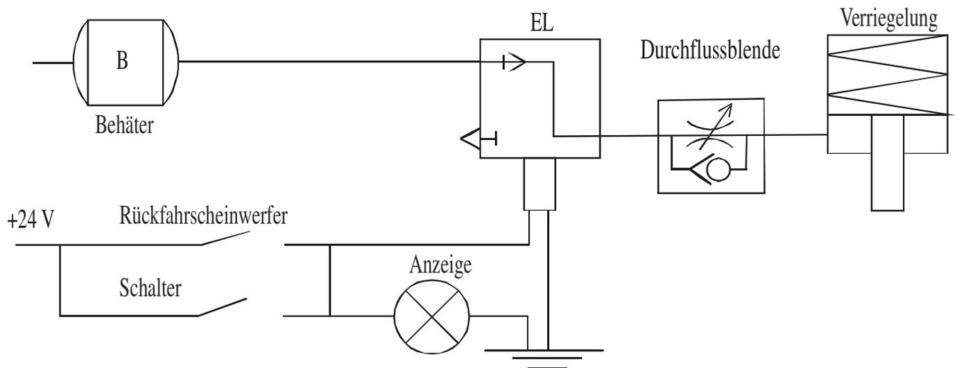
Die Luft gelangt vom Behälter B in das elektromagnetische Ventil (EL), welches geschlossen ist.
