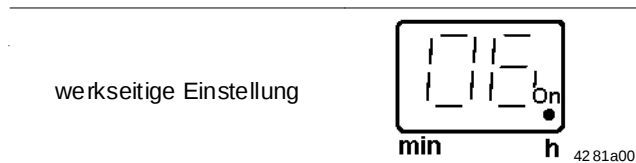
Abb. 12-2 Werkseitige Einstellung der Pausenzeit "P1" (Stunden)
