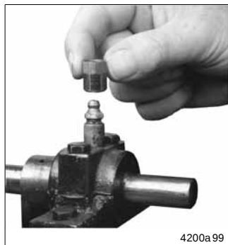
Abb. 2-1 Zerk-Lock-Körper auf den Schmiernippel setzen
