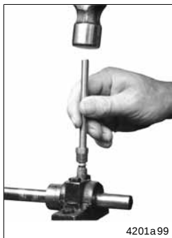
Abb. 2-2 Montage des Zerk-Lock-Körpers mittels Treibwerkzeug
